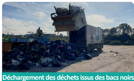
Déchargement des déchets issus des bacs noirs
